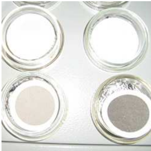
Mit solchen Filtern wird die Masse der Feinstaubpartikel gemessen.
