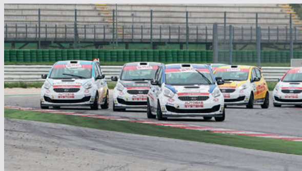
Die BRC-Rennfahrzeuge fahren ausschließlich mit Autogas. Lediglich ein 25-PS-Radnabenantrieb unterstützt sie zusätzlich.
